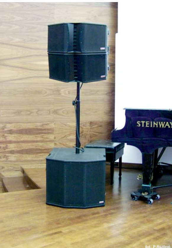
Sala kameralna dysponuje własnym nagłośnieniem, na które składają się po dwa zestawy EAW JFL210 plus subbas JFL118 na stronę.
